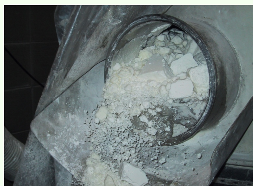
結晶物ろ過 実機 ケーキ排出中
